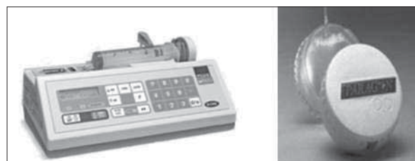
Fig.6.3. Infusor mecánico de resorte flotante y bomba de jeringa.
